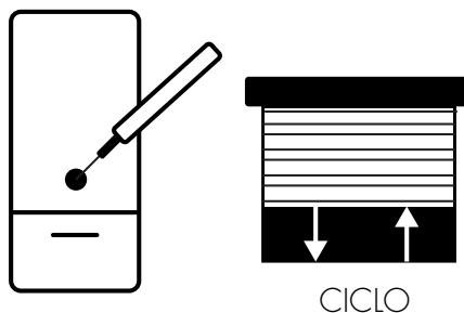
En la aplicación, presiona "Prog" hasta que el motor realice un ciclo, finaliza presionando "OK" para salir de la pantalla Editar.
